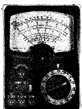
CTR ITI/2 Multitester 21 Meßber. m. Überlastungsschutz. Innenwiderstand: 20 000 Ω/V ~, 10 000 Ω/V ~, Bereiche: Gleichspg. 0 bis 2500 V, Wechselspg. 0 b. 1000 V, Gleichstr. 0 bis 250 mA, Widerst.: 0 b. 6 MΩ, Kap.: 0,01–0,3 μF, M.: 150 × 83 × 29 mm, Gew. 250 g 36.50
