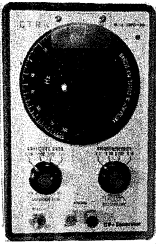
CTR NF-Generator SWG 26 Frequ.-Ber.: 20 Hz–200 kHz bei Sinus und 20 Hz–150 kHz, Rechteck max. 7 V, Ausg.-Imp. 1 kΩ Mit Meßleitung 150.-
